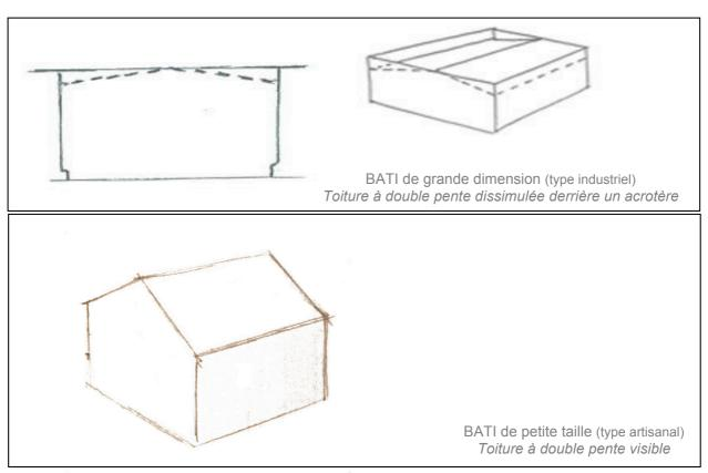
Principe d'aménagement des toitures en fonction du gabarit de construction (et donc du type d'activités)
